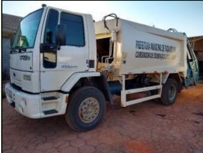
Figura 24 – Caminhão compactador de 12 m 3 utilizado pela coleta regular
