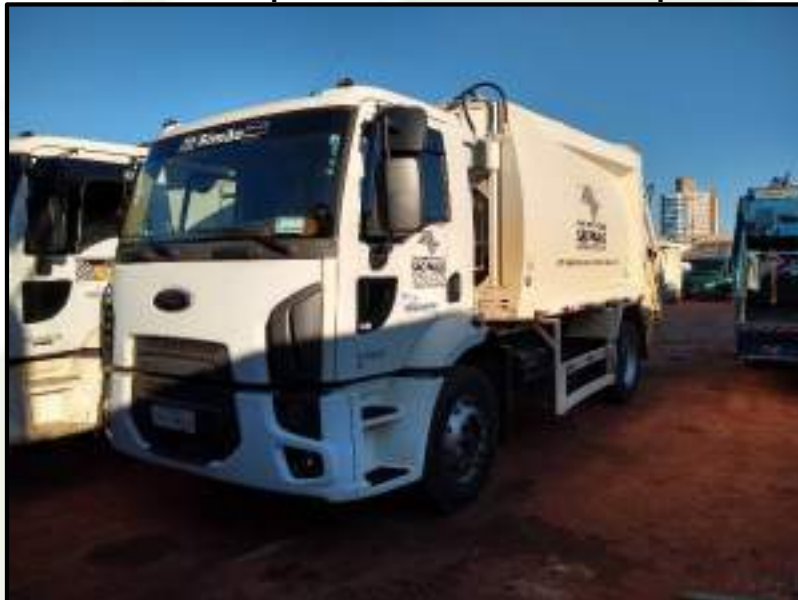
Figura 25 – Caminhão compactador de 15 m 3 utilizado pela coleta regular
